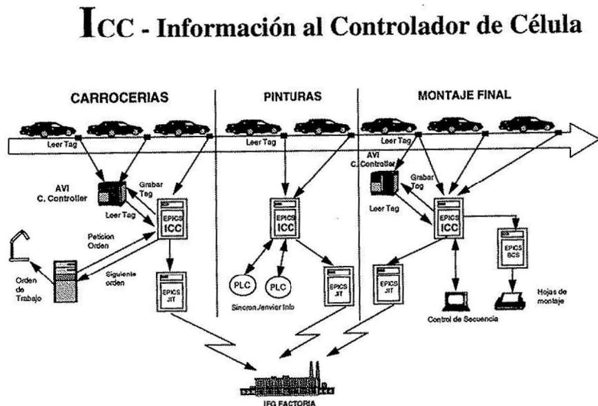
En el ejemplo del gráfico, se representa el proceso de fabricación de un automóvil. Cada vehículo es una orden de trabajo, y ello requiere una identificación individualizada registrada en un dispositivo adjunto a cada chasis.
